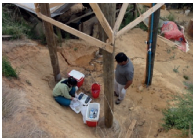
Figura 77: Medición de parámetros químicos de las aguas acumuladas
